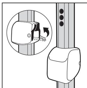
③ Serrare il bloccaggio di azionamento in una posizione in cui siano visibili i tre fori.
