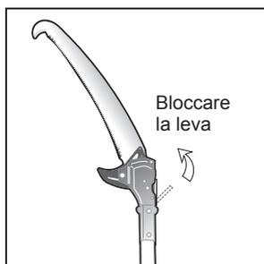
② Bloccare la leva per fissare l'angolazione della lama.
